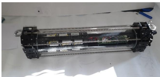
Figure 19 : Hydrophone Jason HighBlue utilisé en suivi acoustique des Dauphins de Guyane
